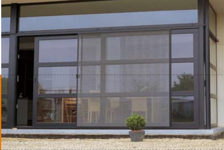
Les portes coulissantes peuvent être réalisées dans pratiquement toutes les dimensions. Pour les plus grandes dimensions, les profilés peuvent si nécessaire être renforcés par l'intérieur au moyen d'un profilé en U de conception spéciale. De cette manière, la ligne originale du système reste parfaitement conservée.
